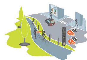
Eco-Totem+czujnik MULTI zliczający pieszych i rowerzystów
