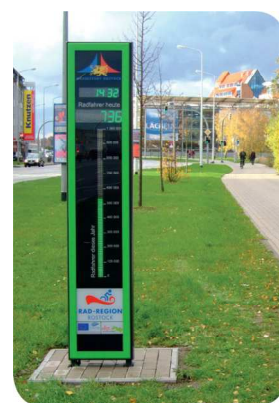
Eco-Totem+czujnik MULTI zliczający pieszych i rowerzystów
